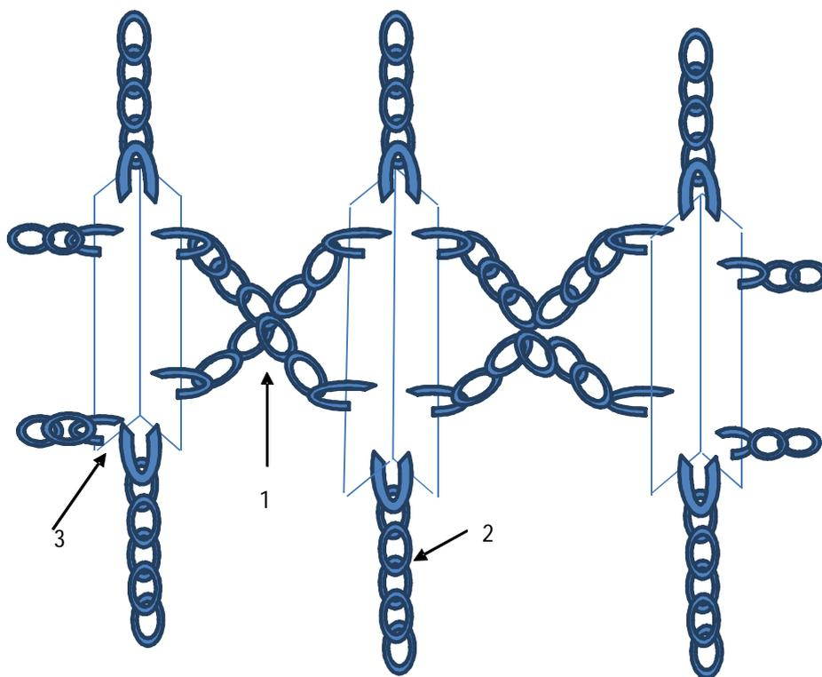
Keterangan (*Remarks*) : 1. Cincin rantai untuk merangkai besi siku dengan bentuk menyilang (*Chain ring for bracket assembling with crossing form*) 2. Cincin rantai sebagai pengunci/penguat pada sisi pinggir ban (*Chain ring as locker/tightener on the tire sides*) 3. Besi siku (*Elbow iron*)
